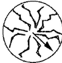
Schéma de la particule montrant les pores
