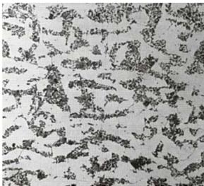
C. Une microstructure montrant de la perlite et de la ferrite
